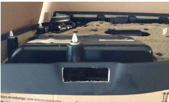
Abbildung 6: Ausgesägtes Loch
