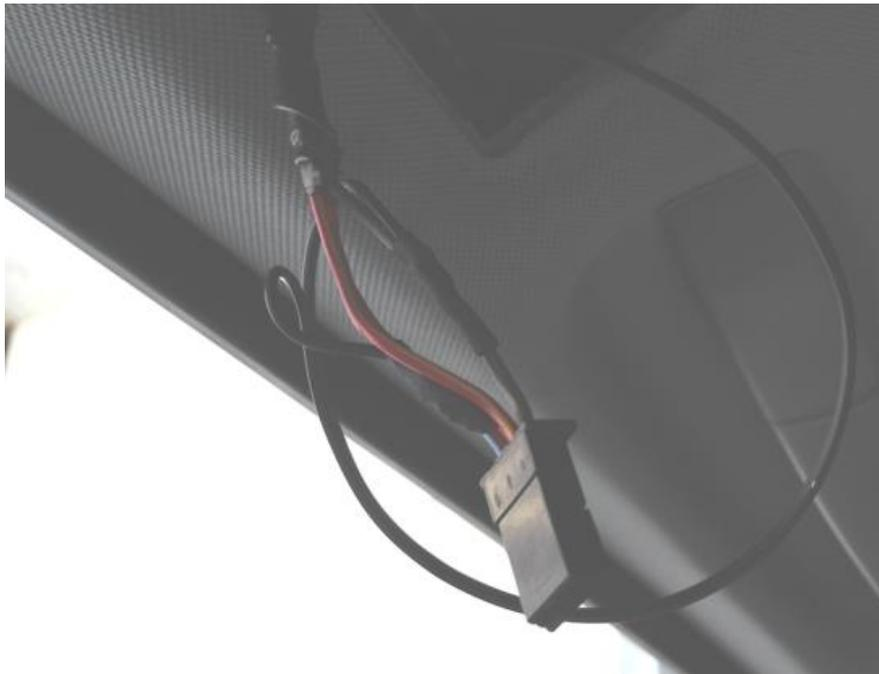
Abbildung 10: Gelötete Kabel
