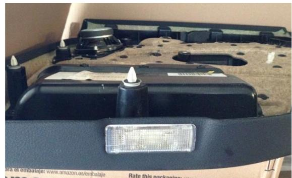
Abbildung 7: Eingesetzte Lampe
