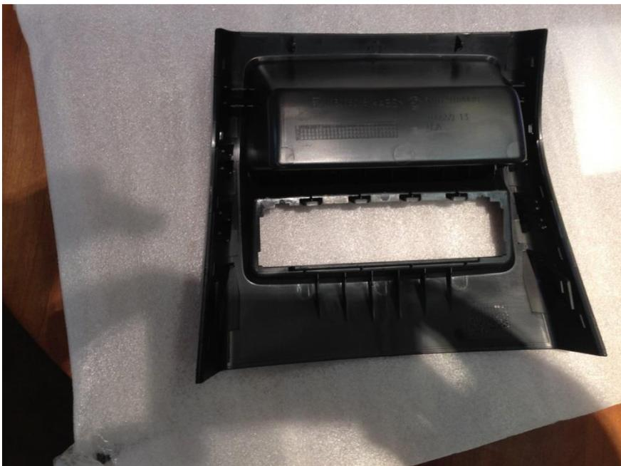
Hier noch die Abdeckung von innen, wenn man vergrößert, erkennt man unten rechts und links die zwei Haltenasen, diese kann man durch das Loch der Blende mit dem Schraubendreher aushebeln, ideal eben unter Sicht.
