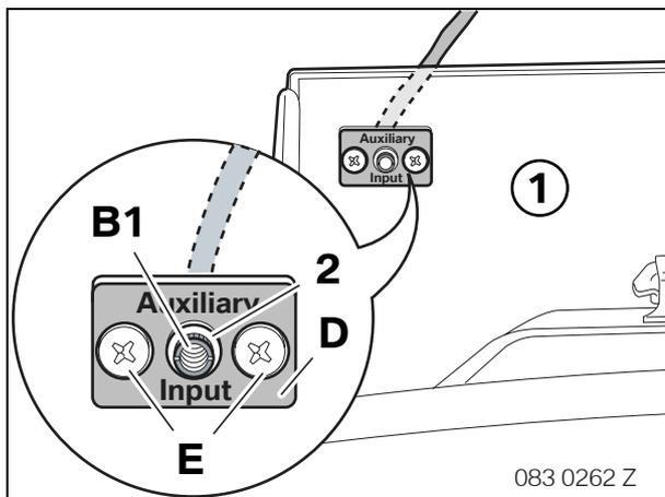
Abzweig **B1** in Handschuhkasten (1) einsetzen und mit Rändelmutter (2) an Befestigungsplatte **D** befestigen.
