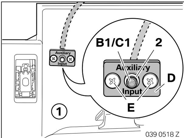
Abzweig **B1/C1** in Handschuhkasten (1) einsetzen und mit Rändelmutter (2) an Befestigungsplatte **D** befestigen.
