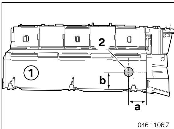
Bohrung (2) mit Spiralbohrer  $\varnothing$  3 mm zur Durchführung des Kabelsatzes AUX-Anschluss in Verkleidung (1) anbringen.
