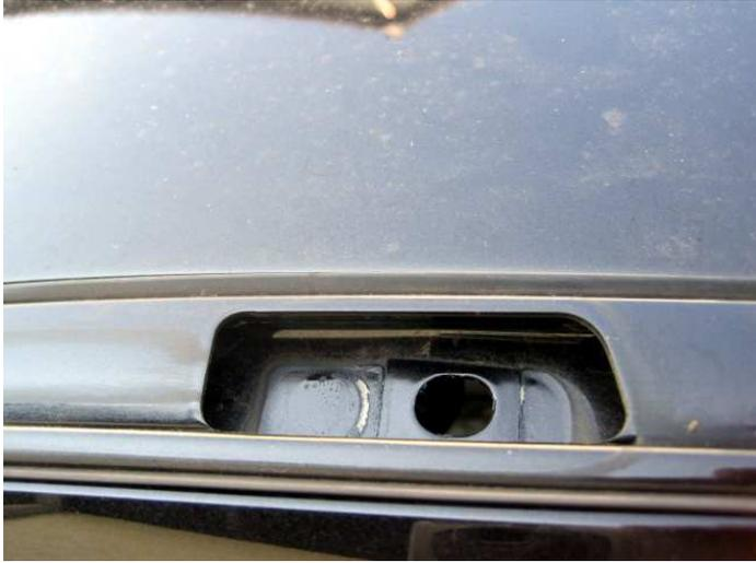
Hier nun das bearbeitete Stück. Es ist blankgeschliffen von 80er, 120er, 300er bis 600er Schleifpapier. Hierzu habe ich einen Schwingschleifer verwendet.
