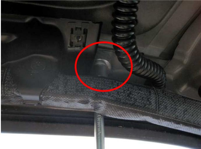
Ist die Mutter ab, so ist noch eine Distanzhülse auf dem Bolzen (Schraube) des Halters der Dachreling.
