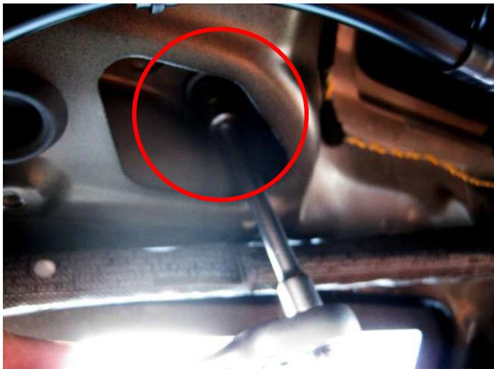
Nun noch die Mutter am mittleren Halter lösen.
