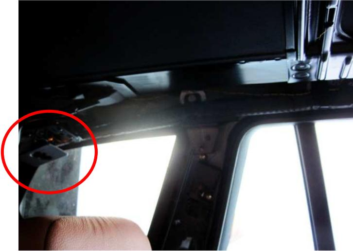
Die Halterung ist mit drei Inbusschlüssel der gösse 4 befestigt. Eine Rechts, eine links und eine unter dem Wasserablauf vom Schiebedach.
