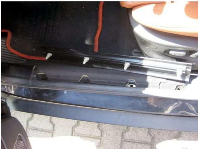
Danach kann man den unteren Teil der B-Säule nach innen ziehen und von den zwei Halteklipps lösen (geht etwas schwer).
