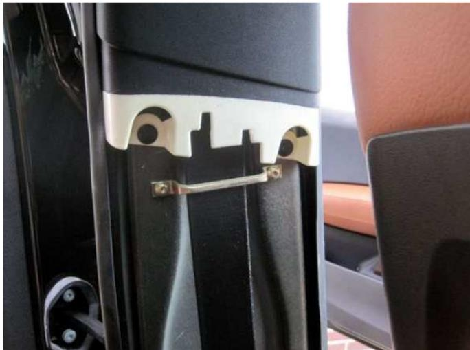
Hierzu mit einem Seitenschneider den Bolzen der Niete ziehen-
