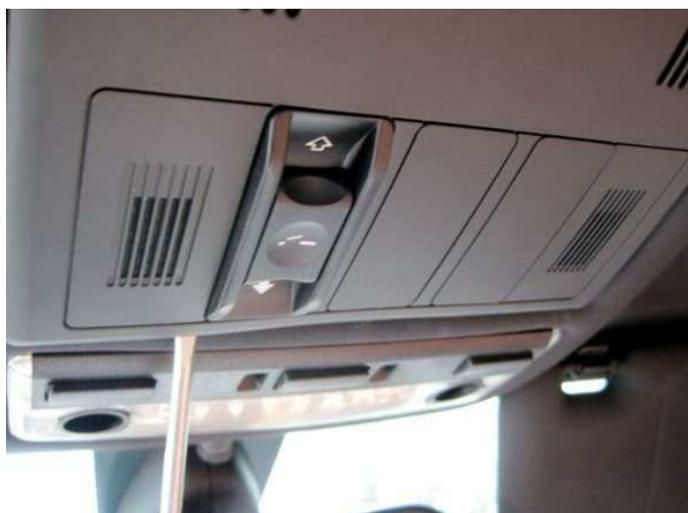
Nun noch den Dachhimmel der hinter der Gummiisolierung ist (allen Türen und Heckklappe) mit einem Schraubendreher hervorholen.
