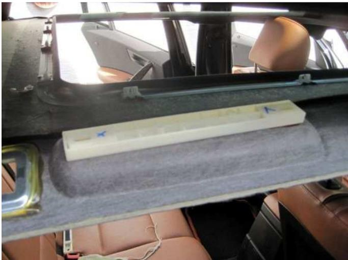
Der Dachhimmel wird mit Hilfe eines Schraubendrehers wieder unter den Gummi gedrückt.
