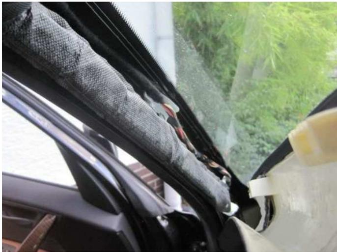
Der Klipp muß später beim Einbau ersetzt werden, da er nicht ohne Zerstörung zu entfernen ist.
