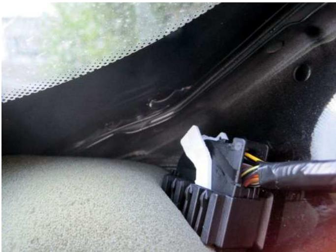
Danach den Dachhimmel nach hinten ziehen, damit sich die Halterung vom hinteren Teil löst.
