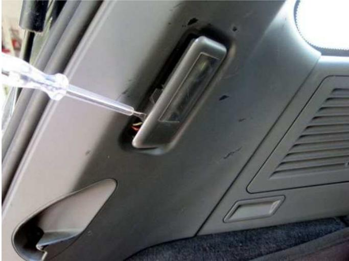
Schraube Lösen an der Halterung für die Gepäckraumabdeckung.
