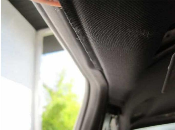
Nun noch am Rand (links, rechts und hinten) vom Panoramadach den Dachhimmel nach unten drücken um die Klippse zu lösen
