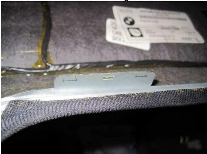
An der A-Säule ist ein Kabelbaum befestigt. Diesen noch vom Halter lösen.
