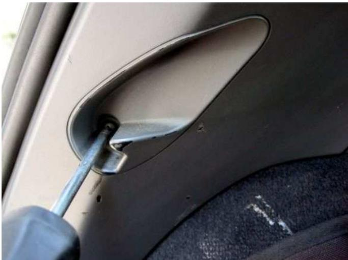
Nun noch die Verkleidung von der Innenseite durch drücken des Knopfes abnehmen und dann eine weitere Schraube lösen.
