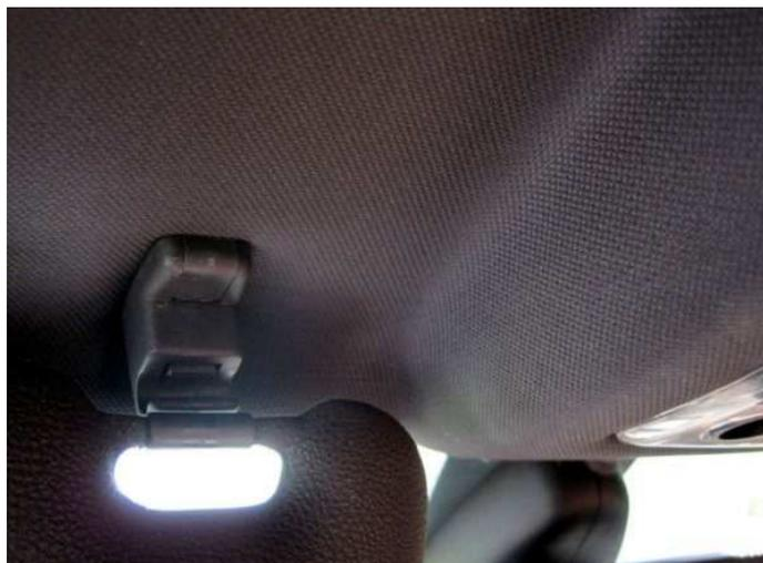
Hierzu die Abdeckung mit einem Schraubendreher abhebeln und die darunterliegende Schraube mit einem 20er Torx lösen.
