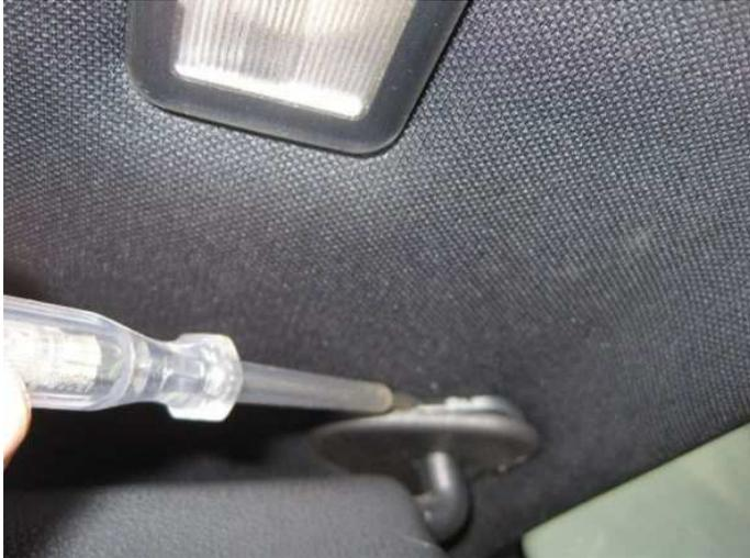
Alle drei Schrauben mit einem 20er Torx lösen.
