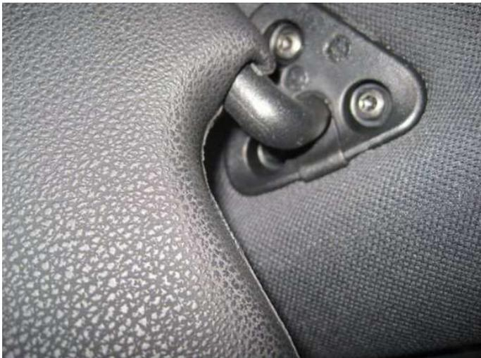
Von der Frontscheibe her zwischen Dachhimmel und Karosserie bis zur Halterung der Sonnenblende greifen. Dann kommt man an einen Stecker. Diesen dann trennen um die Blende entfernen zu können.
