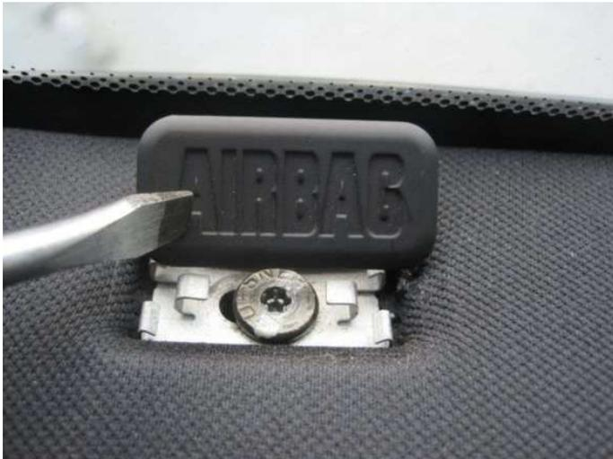
Nun kann man mit einem 20er Torx oder alternativ ein 2,5er Inbusschlüssel nehmen um die Schraube heraus zu drehen.
