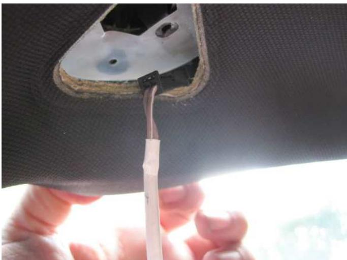
Licht unter der Sonnenblende mit einem Schraubendreher heraushebeln.
