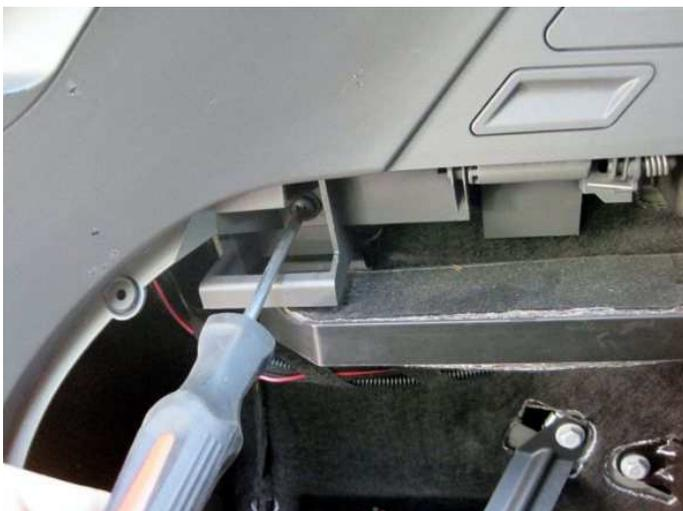
Die Oberseite der Verkleidung der D-Säule nach innen wegziehen. Damit werden zwei Klipps gelöst. Dann die ganze Verkleidung nach oben aus der unteren Halterung ziehen.
