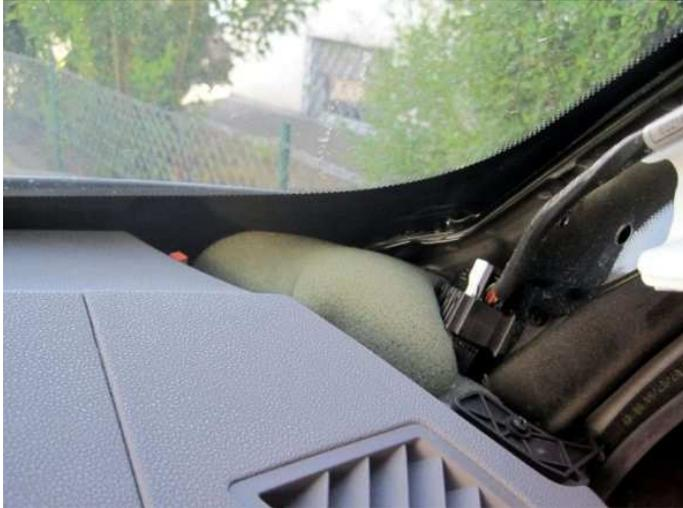
Der Stecker hat auf der Rückseite eine kleine Arretierung. Diese nach unten drücken. Dann kann der Bügel zurückgeklappt werden.
