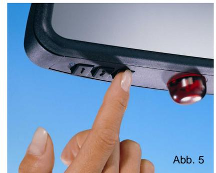
Der erforderliche Abstand zwischen Handsender und HomeLink-Sendereinheit hängt von dem System ab, das Sie programmieren möchten. Möglicherweise sind mehrere Versuche notwendig. Jede versuchte Einstellposition sollte für mindestens 15 Sekunden aufrechterhalten werden, bevor eine andere Position ausprobiert wird.
